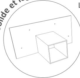
La structure adossée aux murs est maintenue solidement grâce à la large platine et les points de fixations des naissances IP MED®.
